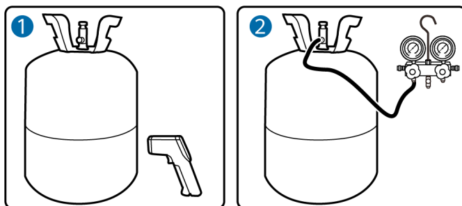
Afbeelding19-18 Het koelmiddel controleren
