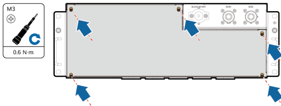
Afbeelding7-21 De kap van het onderhoudscompartiment installeren
