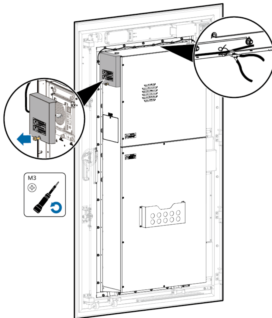
Afbeelding8-3 De communicatiekabel verwijderen
